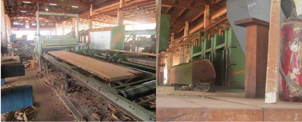
Photos 10 : Sciage en long d'une bille (à gauche) et passage à la déligneuse (à droite)
