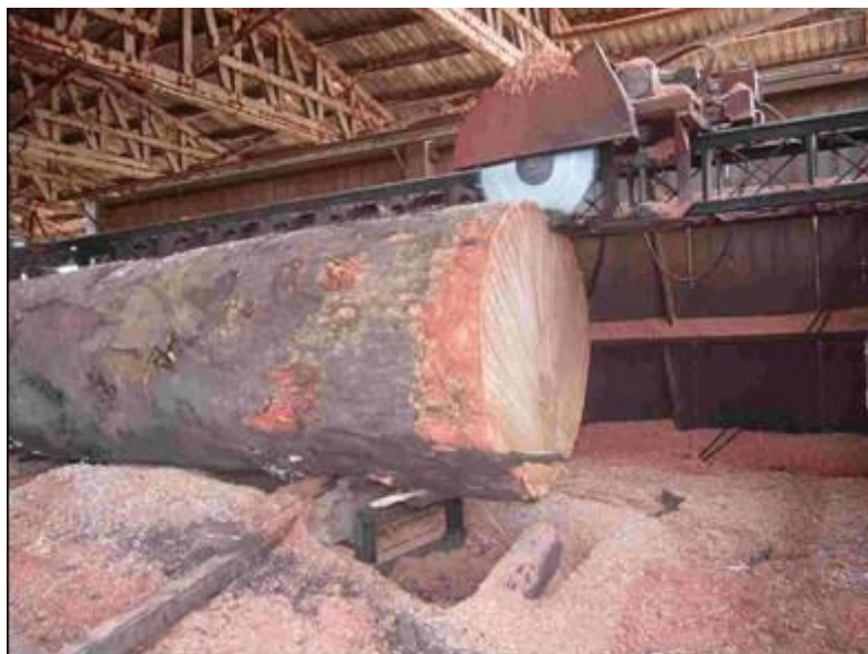
Photo 11 : Passage d'une bille à la scie mixte
