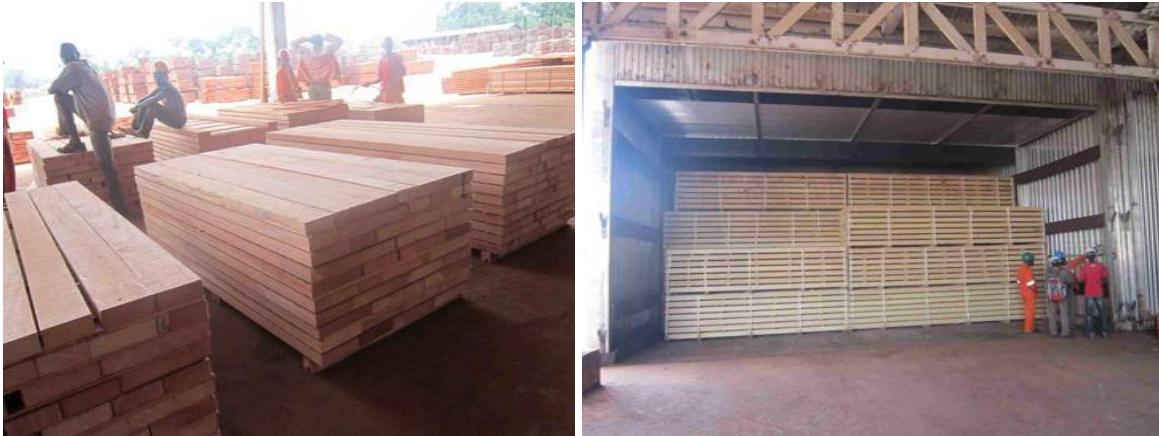
Photos 12 : Colisage (à gauche) et disposition des colis dans le séchoir (à droite)
