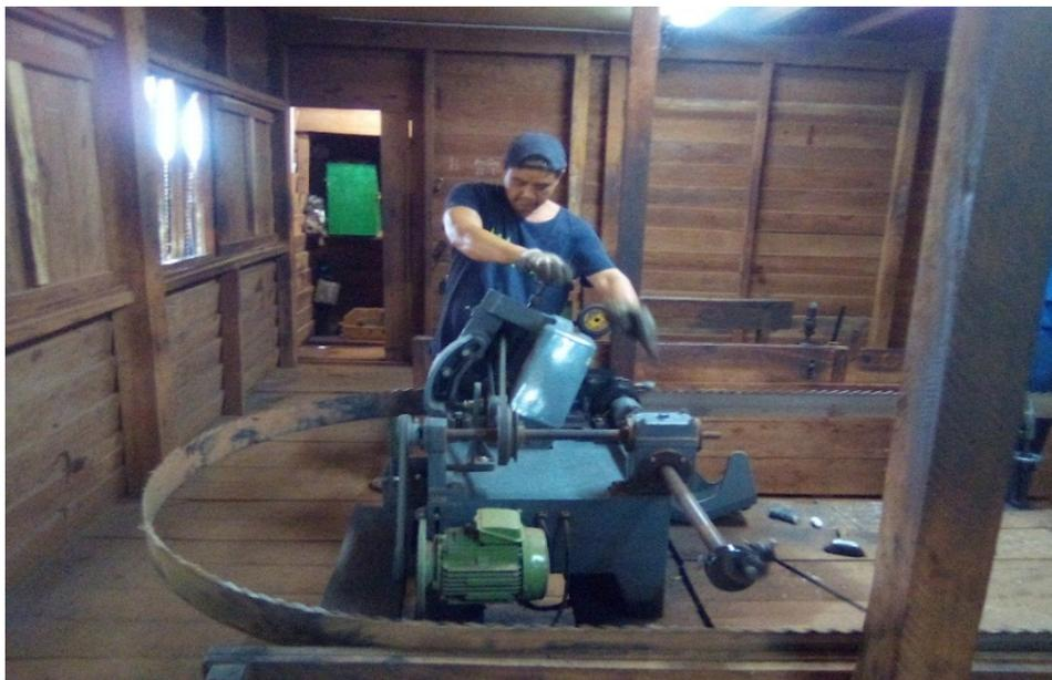
*Figure 16 : salle d'affutage - scie à ruban*
