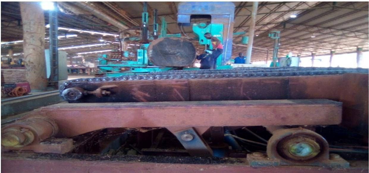
***Figure 8: Grume en position de coupe par la scie de tête***
