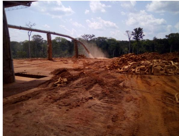
Figure 13: Vue de l'aspirateur et du refoulement de la sciure après coupe
