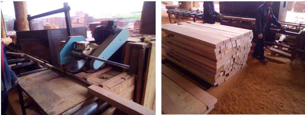
*Figure 12 : Vue de la scie ébouteuse et du bois ébouté prêt pour le colisage*
