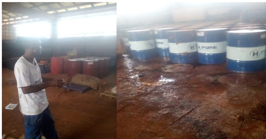
**Figure 10 :** Ouvrier mal équipé et de l'huile se répand au sol
